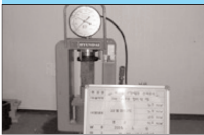
■ 그림 4. 콘크리트 압축강도 시험 (공사체)
