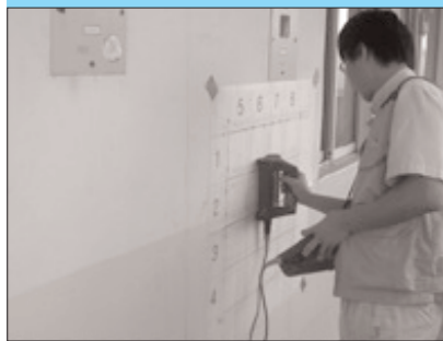
■ 그림 8. 페로스캔을 이용한 측정사진
