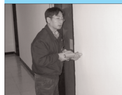
■ 그림 6. 슈미트 햄머를 이용한 측정사진
