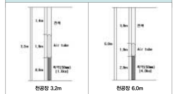
그림 8 | Air Tube재료 및 장약 방법
