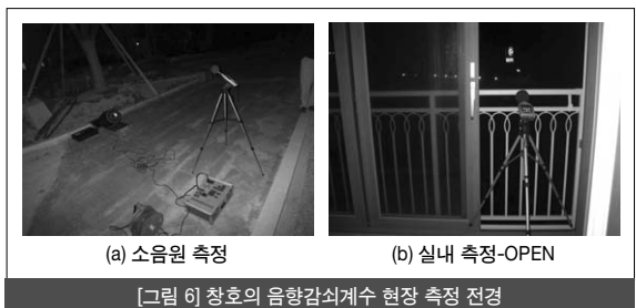
[그림 6] 창호의 음향감쇠계수 현장 측정 전경
