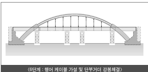
〈6단계 : 행어 케이블 가설 및 단부거더 강부체결〉
