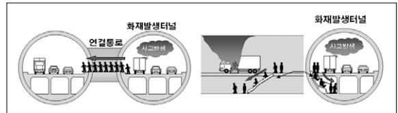
화재시 대피계획은 375m의 일정한 간격으로 대피연결통로를 설치하여 대피안전을 도모할 수 있도록 하였다. 또한 터널의 아래 대피공간을 확보하였으며 피난계단과 연결하였다. 화재시 피난계단을 통해 신속히 이동하여 승객의 안전을 도모할 수 있다.
