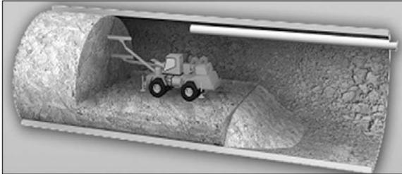
NATM공법은 장약을 통해 지반을 발파 후 지반을 주지보재로 활용하여 터널의 응력을 지탱하고 추가적인 슛크리트 및 록볼트 등의 지보재를 적용하여 보조적인 공법으로 지탱하여 터널을 시공하는 방식이다. 특징으로는 여타의 공법에 비하여 상대적으로 경제성 우수하며 지반 변화에 대한 적응성이 우수하다고 볼 수 있으며 마제형 복선터널 계획으로 굴착단면적을 최적화(굴착 단면적 : 79.50m<sup>2</sup>) 할 수 있다.
